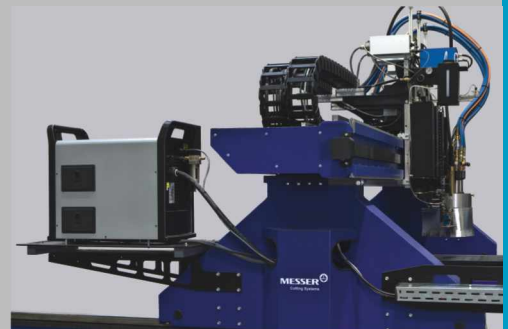
Effizient konstruierte Radkästen mit formschlüssigen Längsantrieben sorgen für große Stabilität. The efficient design of the wheel-housing combined with positive longitudinal drives ensure high stability.
